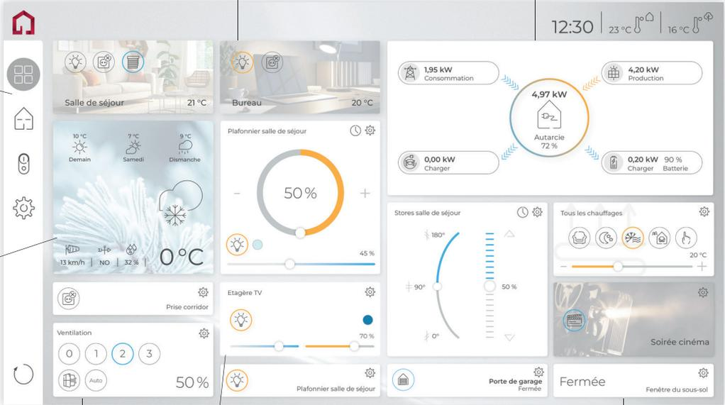
Outre la commande des volets roulants, des stores, des lumières, des variateurs (RGBW), des interrupteurs et des chauffages, il est également facile d'intégrer la station météo.
