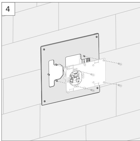
Fixez les fils de câble 24 V provenant de l'alimentation à bornes à vis (GND, 24V) de la plaque de montage du Controlmicro, ou branchez le câble PoE. Connectez le câble KNX et le câble réseau. Fixez la plaque de montage du Controlmicro à l'adaptateur à l'aide des vis fournies.
