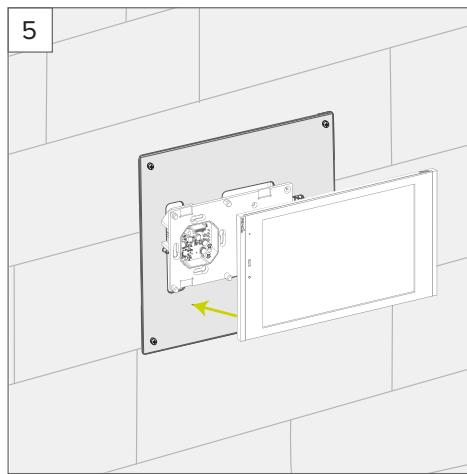
Insérez le panneau sur la plaque de montage et fixez éventuellement les vis sans tête pour assurer la sécurité contre le vol.
