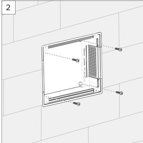
Fixez les adaptateurs directement sur la boîte encastrée du Gira Control 9. Utilisez les vis de montage Gira pour la fixation.
