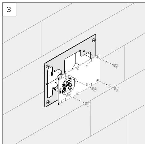
Fixez les fils de câble 24 V provenant du bloc d'alimentation aux bornes à vis (GND, 24 V) de la plaque de montage Controlmicro. Raccordez le câble KNX et le câble réseau. Fixez la plaque de montage du Controlmicro sur l'adaptateur à l'aide des vis fournies.
