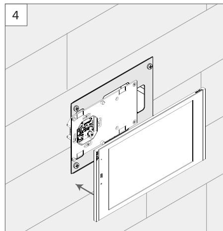
Insérez le panneau sur la plaque de montage et, si nécessaire, fixez les vis sans tête pour empêcher le vol.
