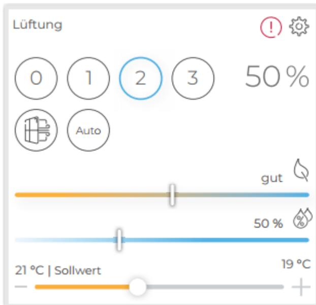
Zur Anzeige des Widgets muss mindestens die Lüftungsvoreinstellung, das heißt die Lüftungsstufe eingegeben werden, bzw. in der ETS mit einer Gruppenadresse belegt werden. Werden die anderen Werte auch mit Gruppenadressen belegt, so werden diese ebenfalls geparsed, sofern sie die folgenden Datentypen enthalten:
