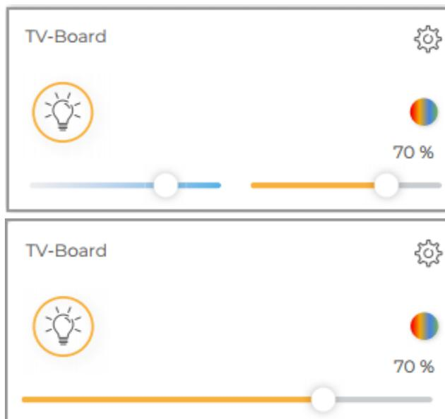
Im Falle des RGBW-Widgets (links) ist der Weißkanal separat ansteuerbar (blauer Slider). Über den orangenen Slider werden die restlichen Kanäle (RGB) gedimmt.
