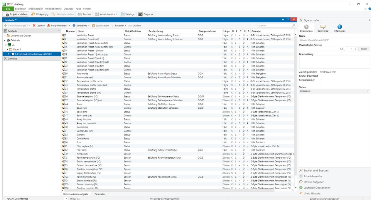
In diesem Beispiel gibt es keinen CO<sub>2</sub>-Wert in der Aktorkonfiguration. Hier kann zusätzlich ein externer CO<sub>2</sub> Sensor für die Anzeige im Widget genutzt werden.
